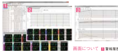
画面について 1 警報履歴 2 リアルタイムトレンド 3 ヒストリカルトレンド
